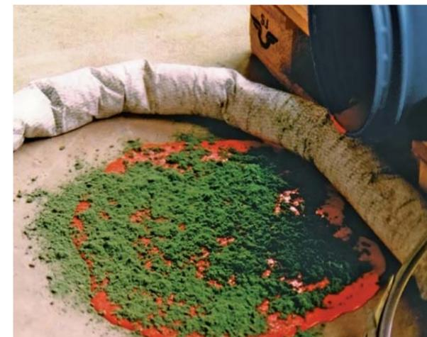
Was tun, wenn pastöse, also dickflüssige Stoffe, wie z. B. Farben, Harze, Lacke oder Kleber im Straßenbereich, auf Industrieflächen oder in Werkhallen ausgetreten sind? Oder wenn bei Reparatur oder Umfüllarbeiten ausgetretene Öle bzw. wässrige Flüssigkeiten eingegrenzt, gestoppt oder aufgefangen werden müssen?
